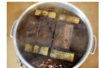
接着重ね梁の接着性能試験
