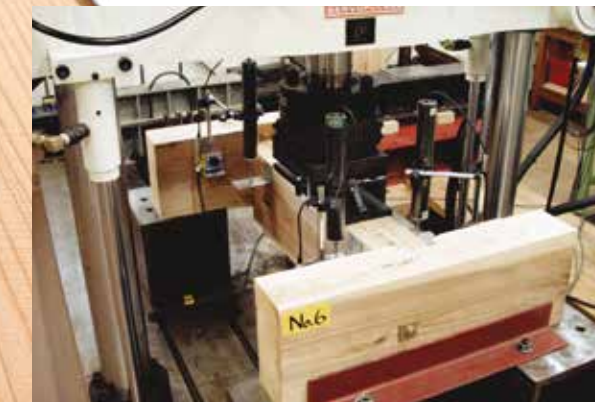
接合部の強度性能試験
