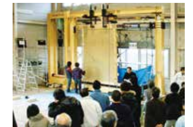
土壁の耐力試験
