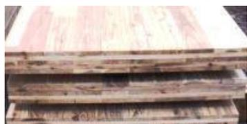
CLTとは、Cross Laminated Timber（クロス・ラミネイティド・ティンバー）の略で、欧州で開発された工法となります。CLTは板の層を各層で互いに直交するように積層接着した厚型パネルのことを呼びます。平成25年12月20日に日本農林規格（JAS）として、直交集成板の名称により制定され、平成26年1月19日に施行されました。
